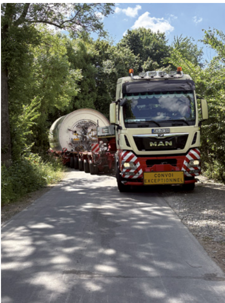
Transport der TBM über eine extra angelegte Baustraße | Foto: Sonntag Baugesellschaft
