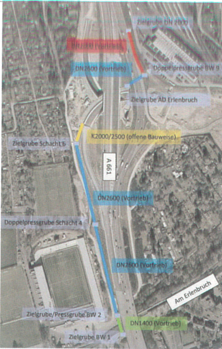
Übersicht Vortriebsstrecken und Baugruben
